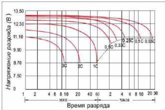
Рис. 3. Разрядные кривые при различном напряжении и токе разряда
