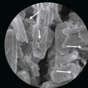
Углеродные нанотрубки, связанные со свинцом в активной массе пластины
