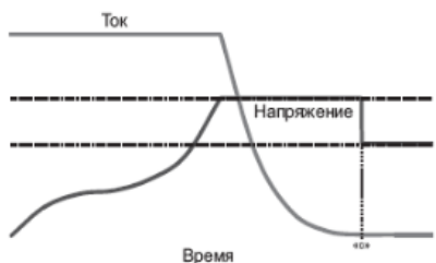
Рис. 4 Зависимость тока и напряжения от времени при заряде по методу IUoU.
