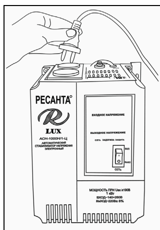
Рис. 4. Подключение нагрузки и включение
