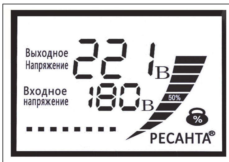
Рис.6. Показания дисплея LCD после включения
