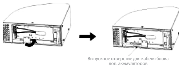
Рис. 9 Снятие направляющих для кабеля
