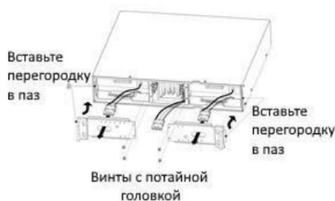
Рис. 5-3 Установка новых аккумуляторных батарей
