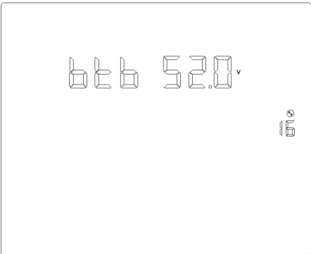
Рис. 1-31. Установка значения напряжения возврата в режим работы от АКБ
