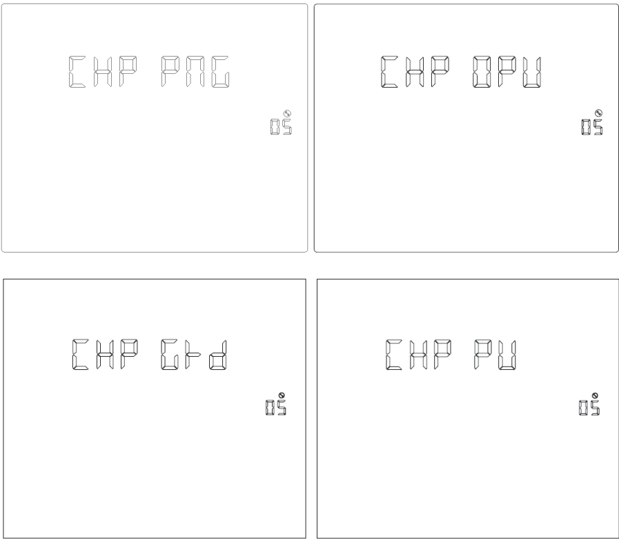
Рис. 1-20. Страница настройки приоритетного режима зарядки (CHP)
