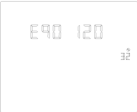
Рис. 1-57. Страница настроек времени задержки выравнивающей зарядки
