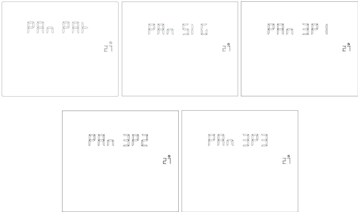
Рис. 1-42. Страница настроек параллельного режима работы
