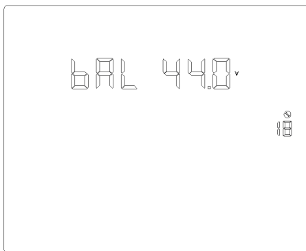
Рис. 1-33. Установка нижнего значения напряжения АКБ
