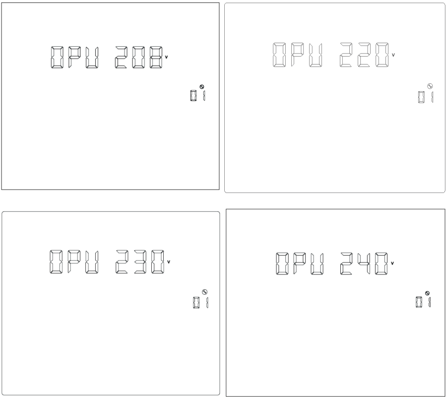
Рис. 1-16. Установка выходного напряжения
