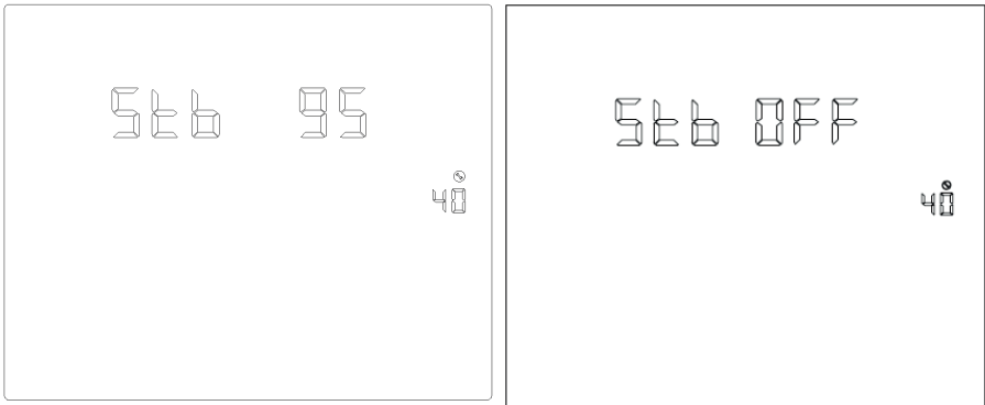
Рис. 1-55. Страница настройки функции переключения в режим работы от электросети при высоком уровне заряда АКБ
