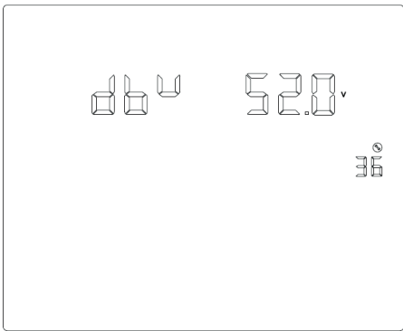
Рис. 1-51-1. Страница установки времени разряда для отключения двойного выхода при работе от АКБ
