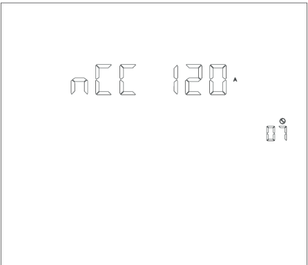
Рис. 1-22. Страница настройки максимального тока зарядки
