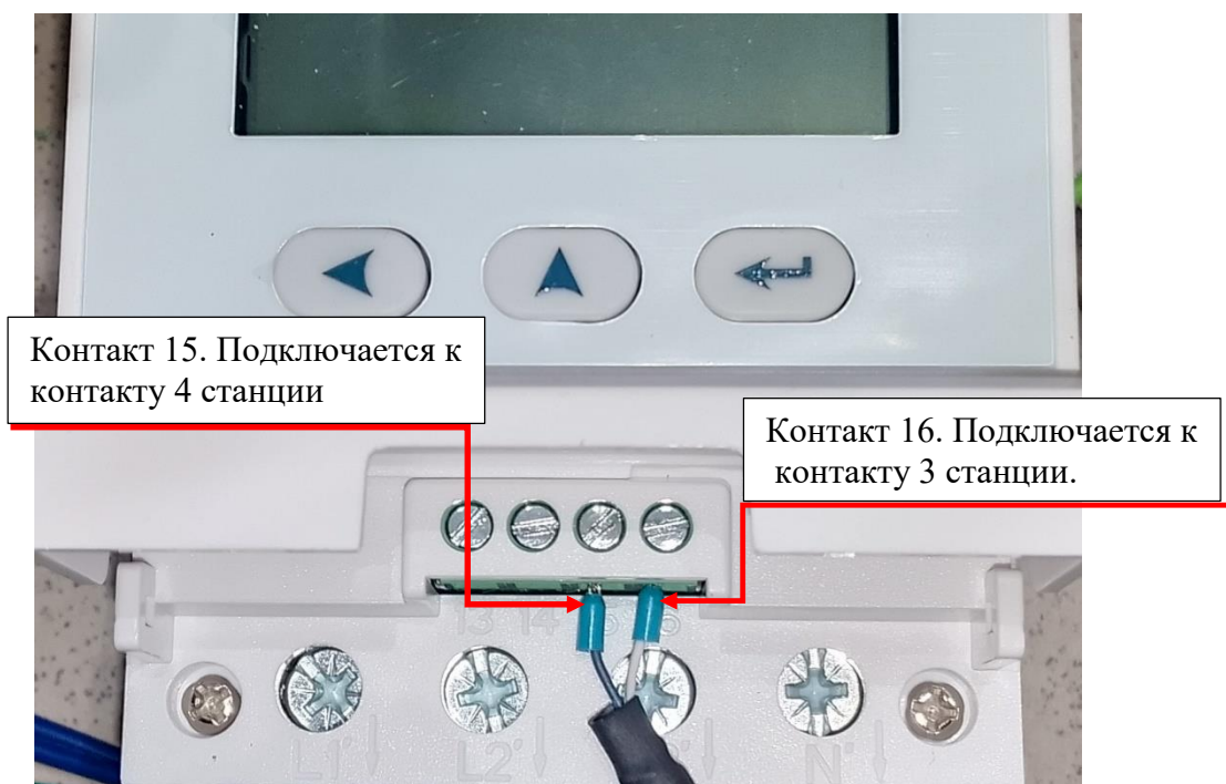
Рисунок 26. Подключение информационного кабеля к клеммам счетчика
